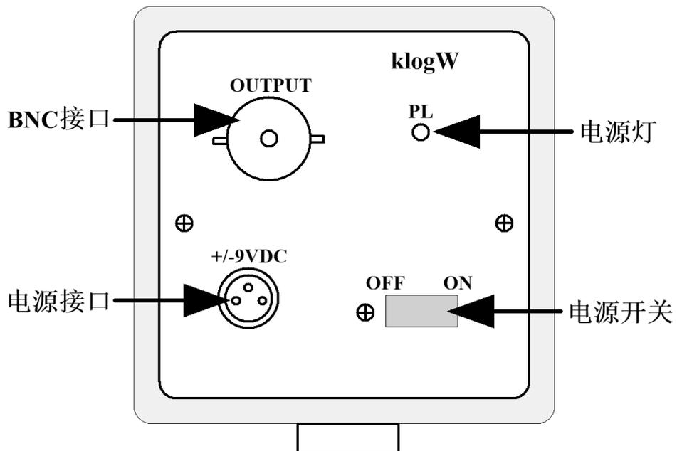
PDA36A5B6G-VIS 光电探测器封装在坚固屏蔽的铝外壳内（53\*50\*50mm）。电器连接以及开关位于光电探测器后侧外壳上。本产品使用小体积，方便在狭小的空间内安装使用。
